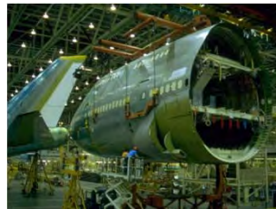
↑モノコック構造のジャンボジェット機
