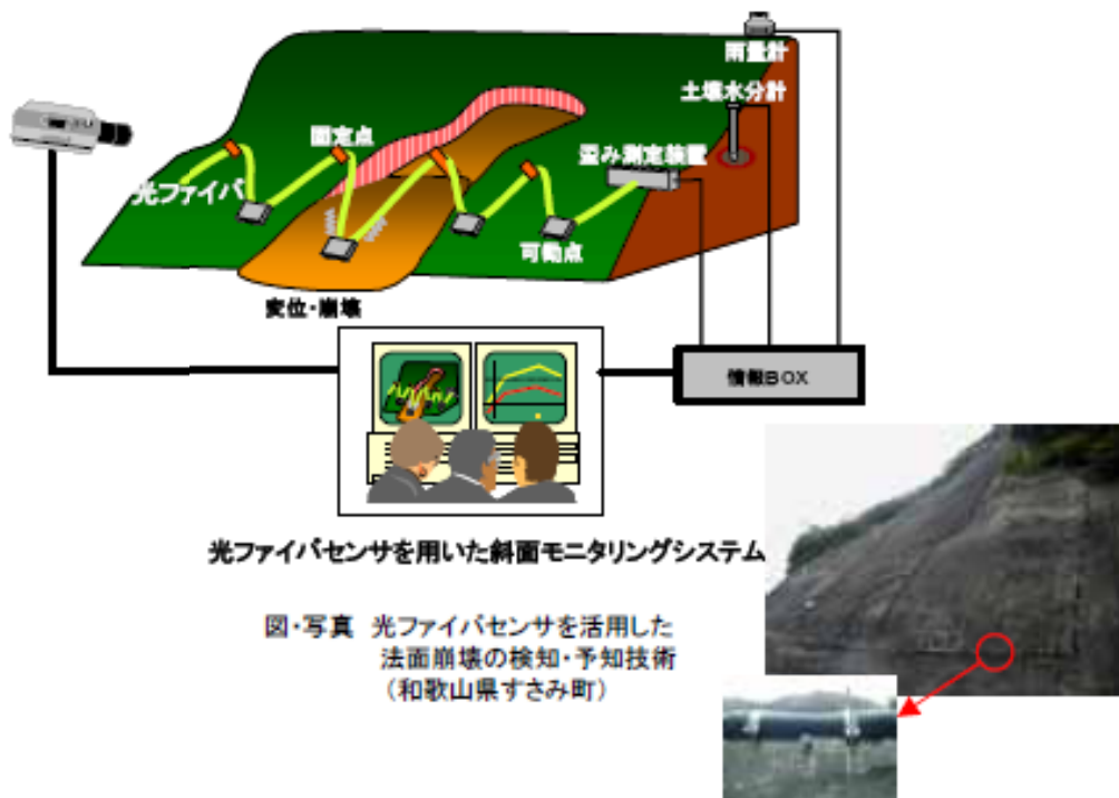
図 光ファイバセンサを用いたモニタリングシステム例（国土交通省資料）
