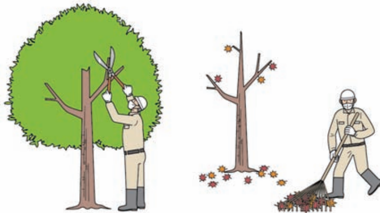
図-2-31：枝打ちによる枝葉の除去と落葉の除去による除染の例
